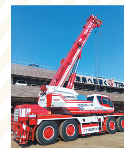
2025年3月31日 35tラフタークレーン (MR350Rf II)
