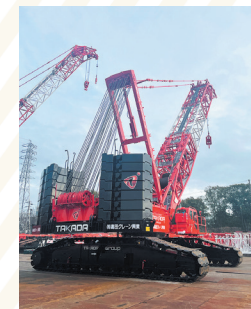
2025年3月17日 350tクローラークレーン (SCX3500-3C5)
